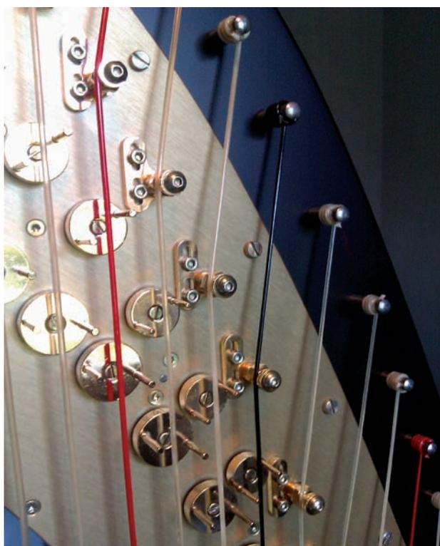
Fig.30 Console. Mécanisme des fourchettes
